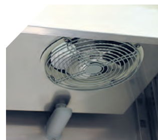
Evaporador de tiro forzado.
