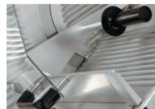
Protecciones de seguridad.
