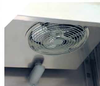
Evaporador de tiro forzado.
